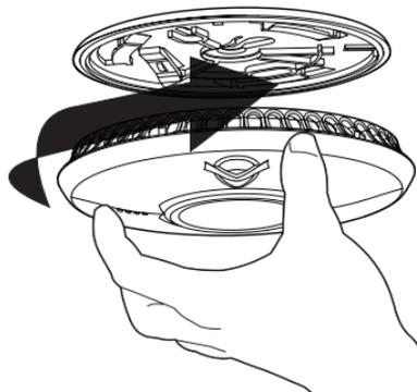
Sobald der Rauchmelder richtig an der Montageplatte befestigt wurde, wird die im Gerät fest integrierte Long-Life-Batterie aktiviert.
