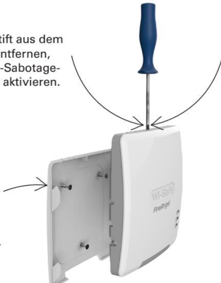
Entfernung: Einen Schraubenzieher in das Loch einsetzen, bis er stoppt. Dadurch wird die Sperre gelöst und das Gateway freigegeben.
