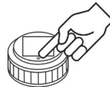
Bei Betätigen der Prüf-/Stopp-Taste erfolgt einmalig ein einfacher Ton (lang: Piep).
