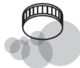
Jeder Alarmton lässt sich durch Betätigen der Prüf-/Stopp-Taste (Abb. I, Punkt d) vorübergehend deaktivieren (Rauchalarm und Temperaturalarm: 10 min).
